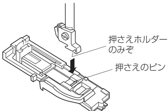
① 押さえホルダーのみぞと、押さえのピンを合わせ、押さえ上げをさげてボタンホール押さえをセットします。
