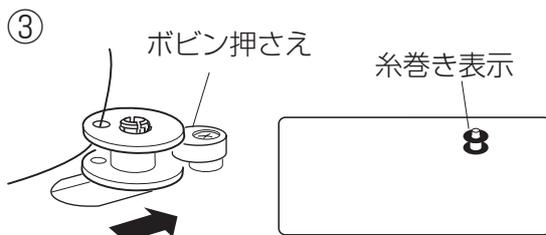
③ ボビンを、ボビン押さえの方に押しつけます。表示画面に糸巻き表示され、糸巻き位置にセットされたことを表示します。
