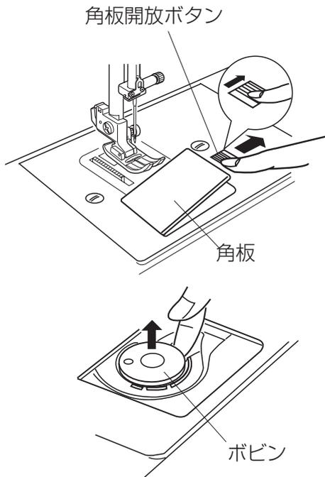
角板開放ボタンを右へずらして角板を外し、ボビンを取り出します。
