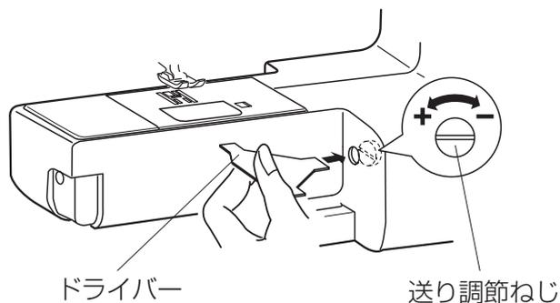
布の種類などによっては、模様の形がくずれる場合もあります。実際にぬうときと同じ条件で試しぬいをしながら、送り調節ねじで調節してください。(補助テーブルを外します。)
