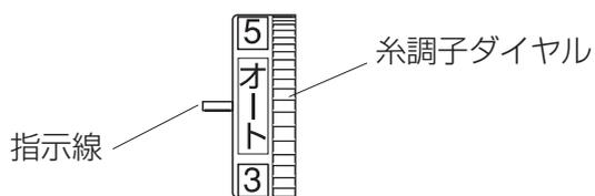
糸調子ダイヤルの「オート」を指示線に合わせると、上糸と下糸がバランス良くぬえるように、自動セットされます。
