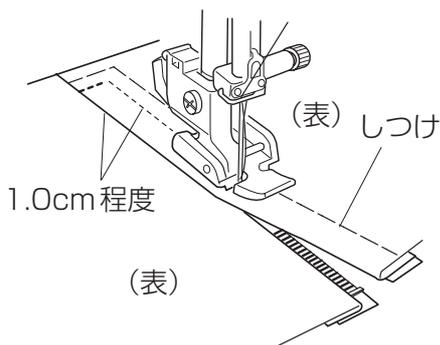
② 押さえホルダーを押さえの右側にセットして、むしのきわに押さえの端をあてて、あき止まりからぬいます。
