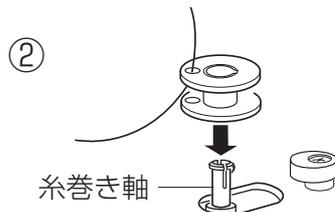
② ボビンの穴に糸を通し、糸巻き軸に差し込みます。
