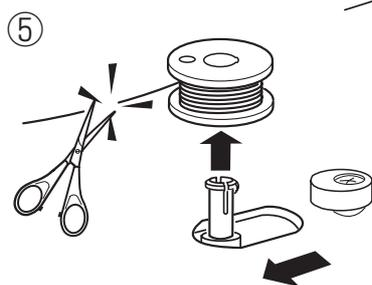
⑤ ふたたびスタートして、巻き終わるとボビンの回転が止まります。ミシンを止めます。糸巻き軸を戻し、糸巻き軸からボビンを外し、糸を切ります。
